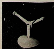
Bild 9 (unten). UHF-Zimmerantenne „FIA 1 Q 2“ von Fuba mit Reflektor
